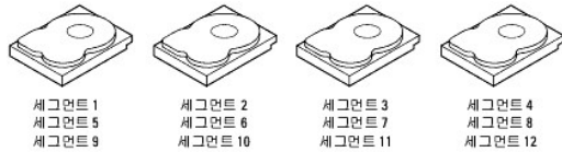
그림 2-1. 디스크 스트라이핑의 예 (RAID 0)
